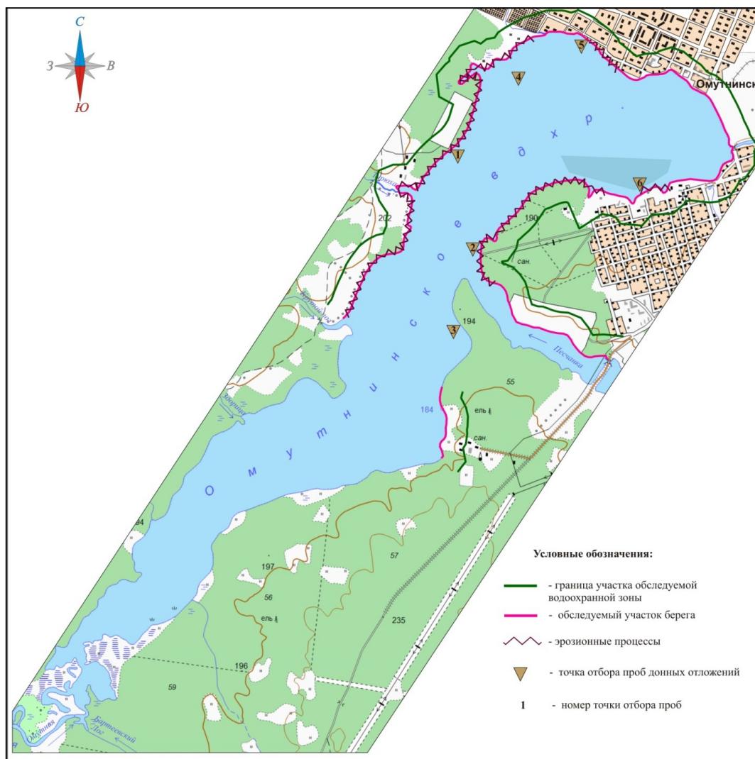
Рис. 4.7.11. Схема расположения участков наблюдения состояния водоохранной зоны, берега, дна и донных отложений Омуртинского водохранилища в г. Омуртинск
